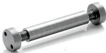
Zapfenlager für großkalibrige Repetierbüchsen. Einstellbar an verschiedene Schaftbreiten. Besteht aus einer Gewindebuchse und 2 Lochschrauben.
