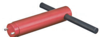
Zapfenlager für großkalibrige Repetierbüchsen in besonders robuster Ausführung. Die beiden Lochschrauben ermöglichen die Einstellung auf verschieden breite Schäfte sowie eine mittige Positionierung der Gewindebuchse. Die Abflachungen und die Aussparung am Zapfenlager garantieren eine große Anlagefläche am System.
