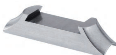
Visiersattel für Super-Express-Visier mit 2 Klappen. Laufradius: R 10,5; H: 6 mm
