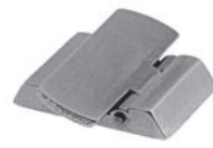
Umlegevisier mit einer Klappe. Prisma 30° / Länge 19 mm / Breite 12 mm
