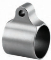
Ringriemenbügel in besonders schlanker Ausführung, zylindrisch. Kopfbreite: 8 mm; Bohrung: \varnothing 3,6 mm; Ringbreite: 20,0 mm.
