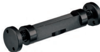
Zapfenlager für großkalibrige Repetierbüchsen in besonders robuster Ausführung. Die beiden Lochschrauben ermöglichen die Einstellung auf verschieden breite Schäfte sowie eine mittige Positionierung der Gewindebuchse. Die Abflachungen und die Aussparung am Zapfenlager garantieren eine große Anlagefläche am System.
