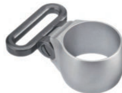
Classic-Ringriemenbügel für Repetierbüchsen. Kopfbreite: 6 mm; Bohrung: \varnothing 3,0 mm; Ringbreite: 15,0 mm.
